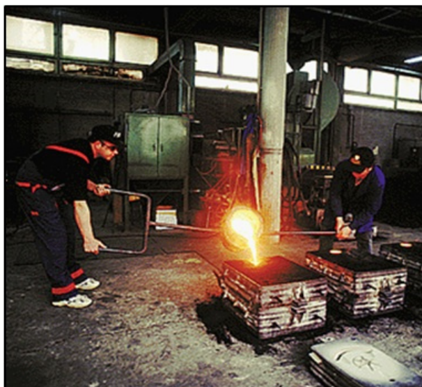
Slika 8. Ulijevanje taline u jednokratni kalup
