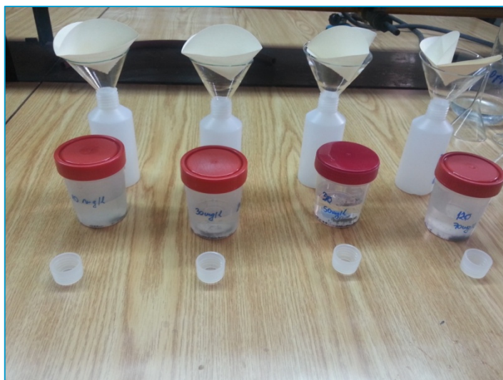
Slika 13. Provođenje adsorpcijskog eksperimenta
