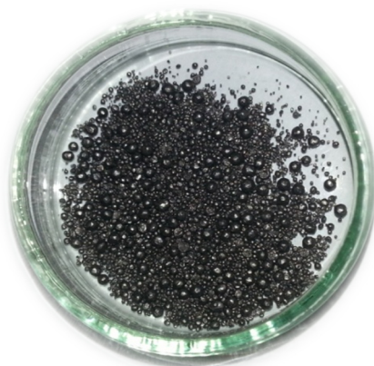
Slika 12. Otpadna čelična sačma
