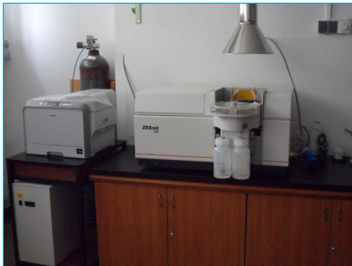
Slika 14. Atomski apsorpcijski spektrometar
