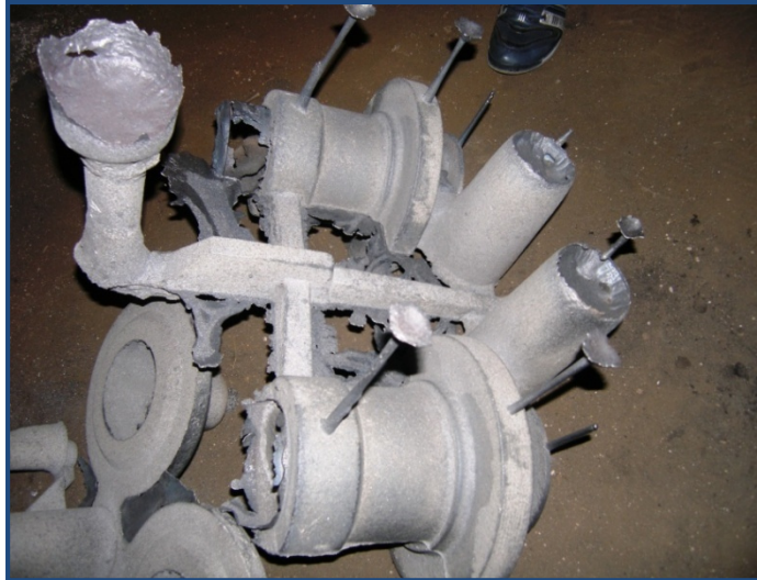
Slika 9. Izgled odljevka nakon vađenja iz jednokratnog kalupa
