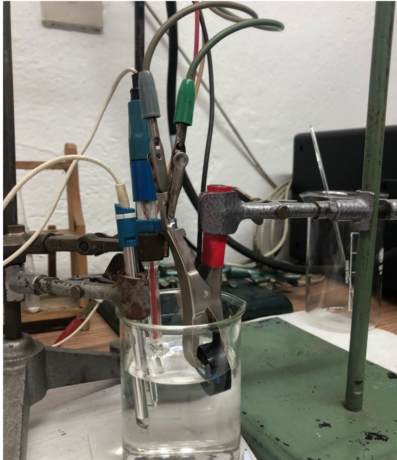
Slika 31. Troelektrodna staklena ćelija za elektrokemijska ispitivanja
