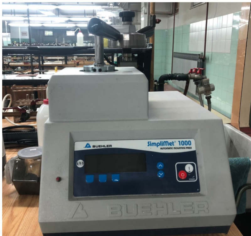
Slika 33. Buehler SimpliMet™ 1000 uređaj za ulaganje uzoraka u ugljičnu masu postupkom vrućeg prešanja
