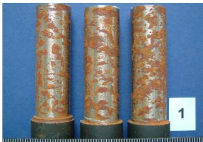
Slika 26. Uzorci bez dodatka inhibitora nakon ispitivanja u slanoj komori [42]
