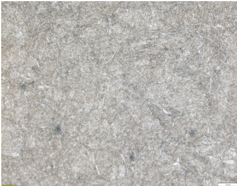
Slika 42. Mikrostruktura alatnog čelika za topli rad oznake UTOPMO1 nakon nagrivanja u nitalu: a) povećanje 50x i b) povećanje 200x
