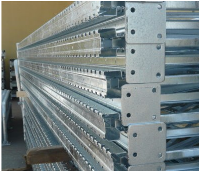
Slika 15. Proizvodi zaštićeni metodom vrućeg pocinčavanja [22]
