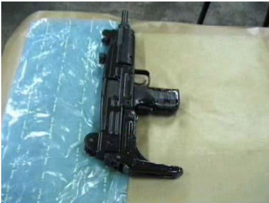
Slika 28. Folija impregnirana hlapljivim inhibitorom za zaštitu oružja [42]
