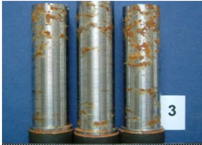
Slika 27. Uzorci s dodatkom inhibitora nakon ispitivanja u slanoj komori [42]
