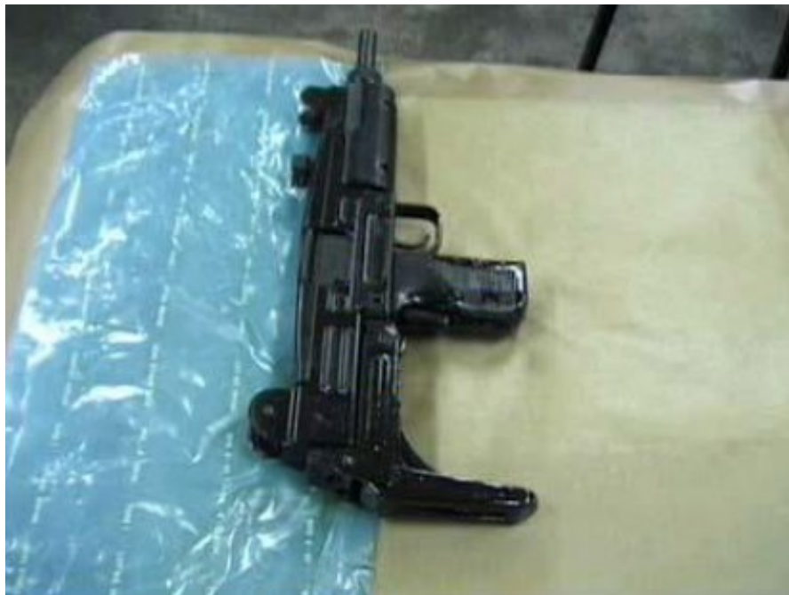
Slika 28. Folija impregnirana hlapljivim inhibitorom za zaštitu oružja [42]
