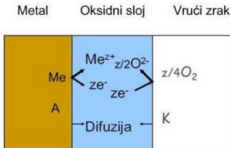
Slika 2. Oksidacija metala u vrućem zraku [5]
