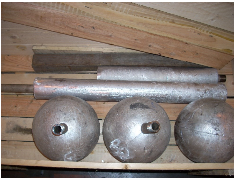
Slika 13. Oblici žrtvenih anoda [19]
