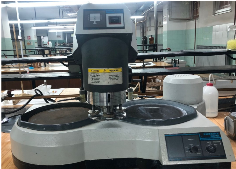
Slika 34. Bühler uređaj za automatsko brušenje i poliranje uzoraka
