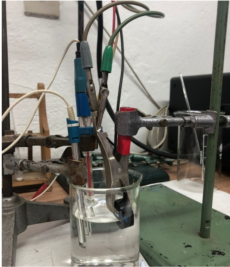
Slika 31. Troelektrodna staklena ćelija za elektrokemijska ispitivanja
