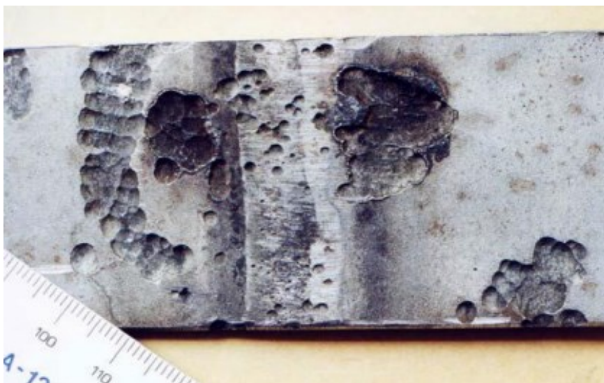
Slika 7. Pjegasta korozija čelika u morskoj vodi [12]
