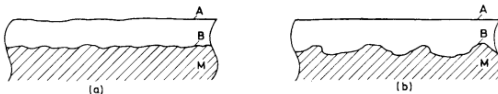
Slika 6. Opća korozija: (a) ravnomjerna i (b) neravnomjerna [2]
