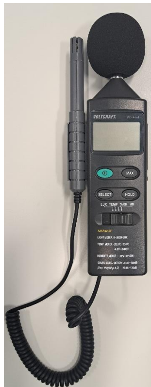
Slika 48 Zvukomjer korišten u eksperimentalnom dijelu
