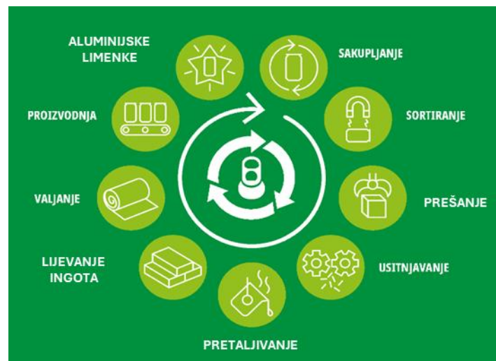
Slika 9. Koncept recikliranja aluminijskih limenki u zatvorenoj petlji [52]
