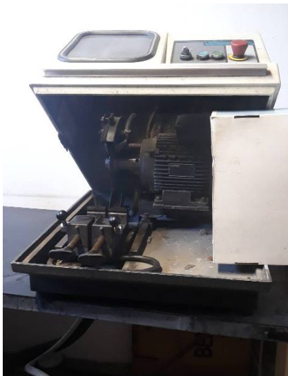
Slika 71. Uređaj za rezanje Buehler ABRASIMET 2
