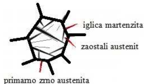
Slika 43. Rast iglica martenzita [5]
