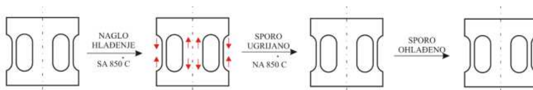
Slika 20. Shematski prikaz uklanjanja zaostalih naprezanja [35]
