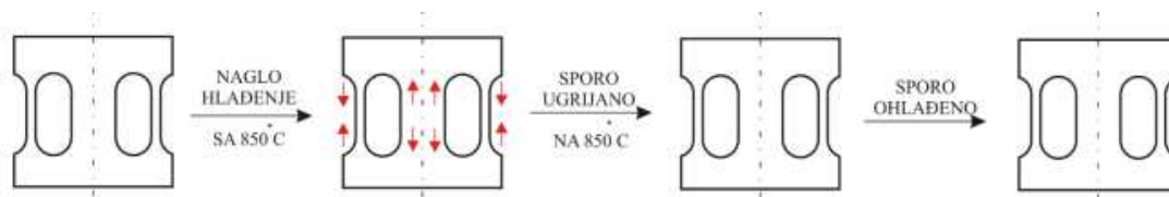
Slika 20. Shematski prikaz uklanjanja zaostalih naprezanja [35]
