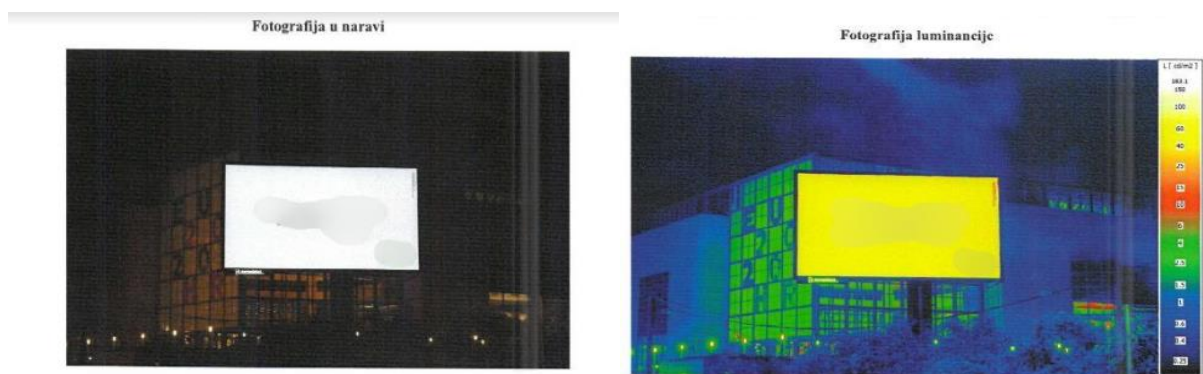
Slika 4. Svjetlotehnička mjerenja luminancije reklamnog panoa kod Nacionalne knjižnice u Zagrebu [12]
