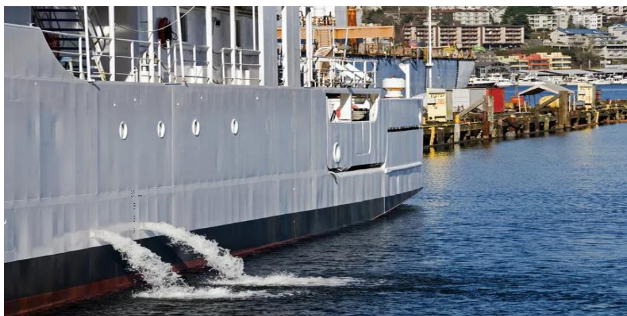
Slika 9. Ispuštanje balastne vode [32]
