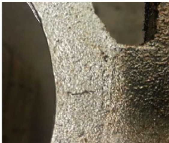
Slika 5. Topla pukotina na prstenu širine 11 mm, legura AlMg1
