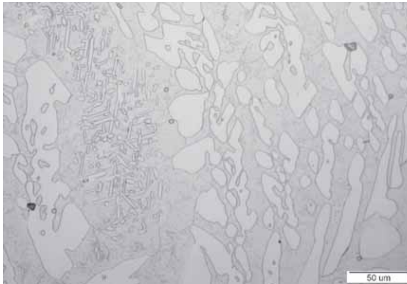
Slika 4. Mikrostruktura dupleks nehrđajućeg čeličnog lijeva GX2CrNiMoN25-6-3
