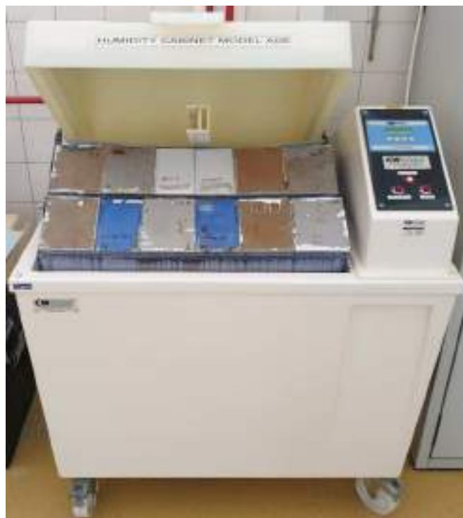
Slika 1. Ispitivanje uzoraka u vlažnoj komori
