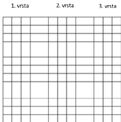
Slika 4. Shematski prikaz uzorka sa tri vrste elektro-otpornih zavara za testiranje u slanoj komori
