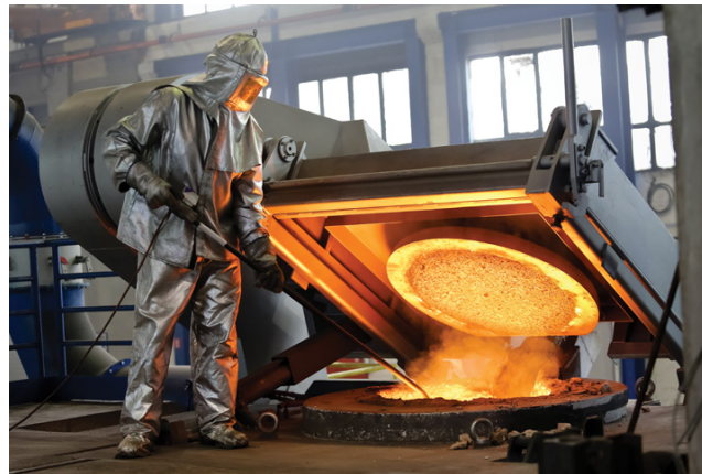
Radnik na peći za taljenje metala u čakovečkom poduzeću Ferro-Preis, 2015.
