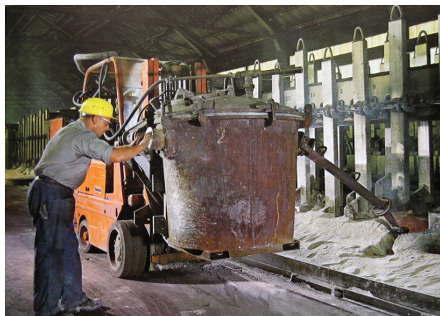
Probijanje elektrolitičke kore i sakupljanje aluminija u vakuumski lonac u proizvodnom pogonu Ražine, Tvornica lakih metala Boris Kidrič, Šibenik
