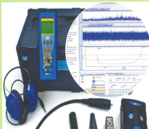
Tehnična diaagnostika: ultrazvok, vibracije in termografija
