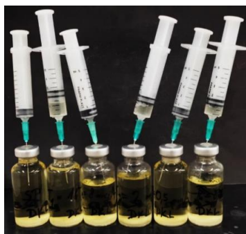
Slika 4. Provođenje testa ekotoksičnosti diklofenaka primjenom kvasca Saccharomyces cerevisiae
