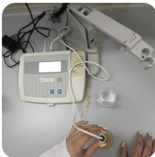
Slika 4. Određivanje pH-vrijednosti (izvor autor) Figure 4. Determination of pH value (source author)
