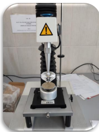
Slika 6. Prikaz prodiranja nastavka za teksturu konusnog oblika (izvor autor) Figure 6. View of the penetration of the conical texture attachment (source author)
