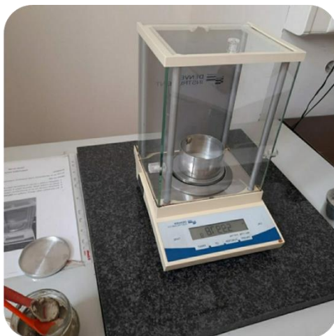
Slika 2. Prikaz vaganja uzorka za određivanje ukupne vlažnosti (izvor autor) Figure 2. Display of sample weighing to determine total humidity (source author)
