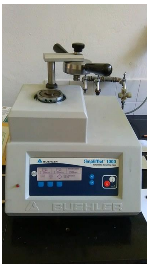
Slika 20. Fotografija uređaja za ulaganje uzoraka u vodljivu masu Buehler Simplimet 1000
