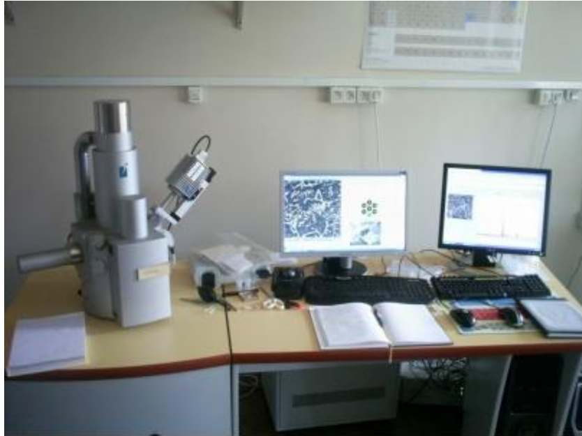
Slika 31. Fotografija pretražnog elektronskog mikroskopa Tescan Vega TS 5136
