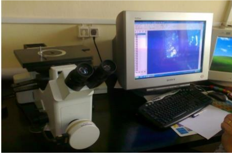
Slika 30. Fotografija svjetlosnog mikroskopa Olympus GX51
