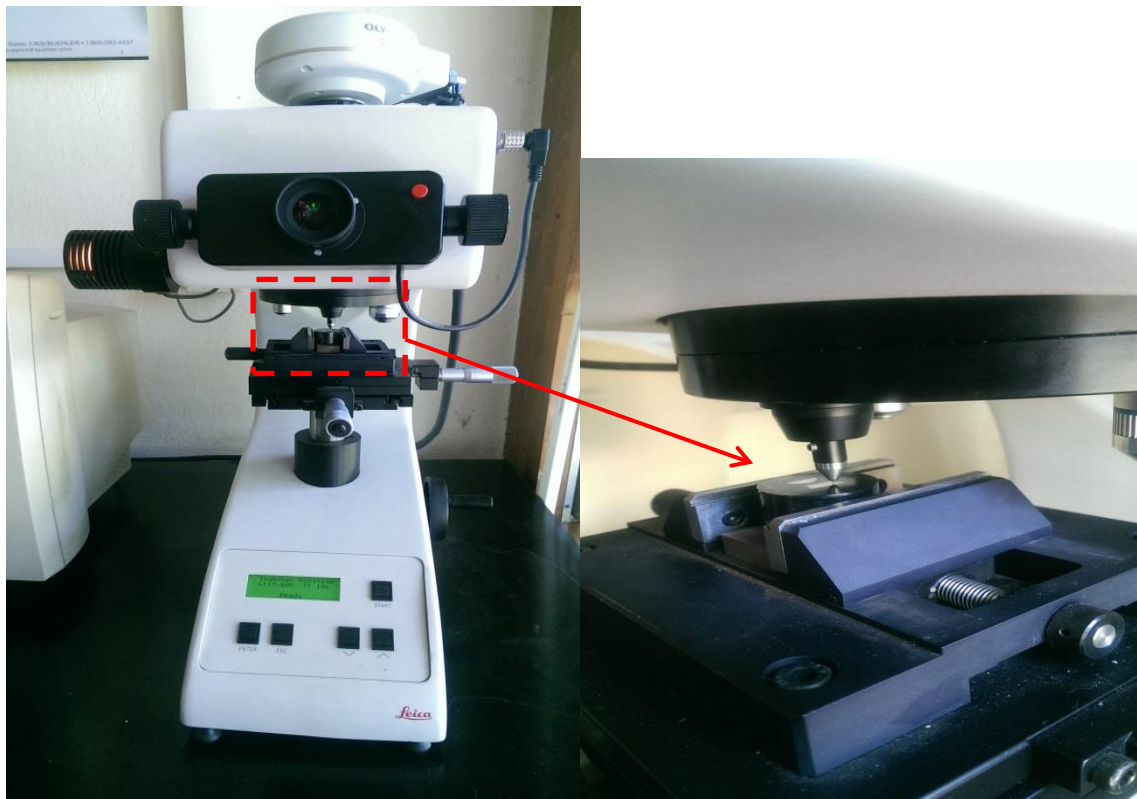
Slika 27. Fotografije tvrdomjera Leica korištenog za ispitivanje tvrdoće
