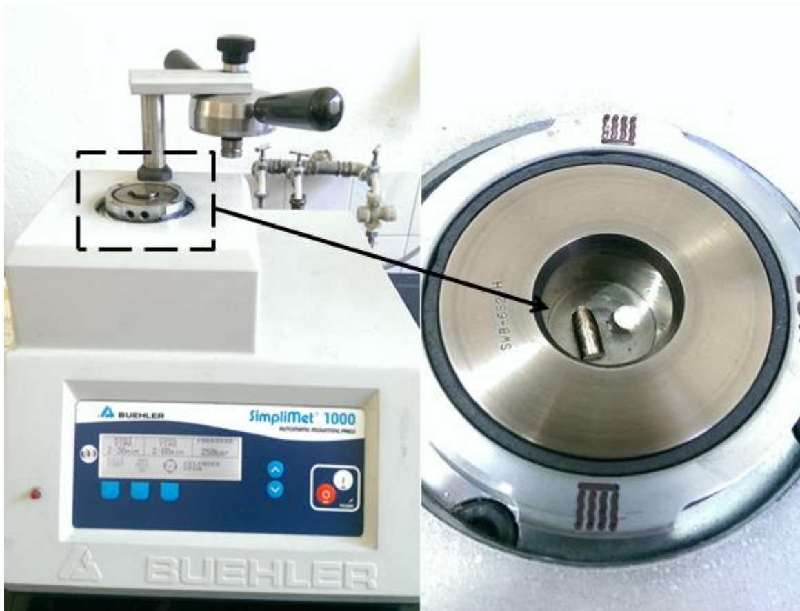
Slika 21. Fotografija uređaja Buehler Simplimet 1000 korištenog za ulaganje uzoraka u vodljivu masu
