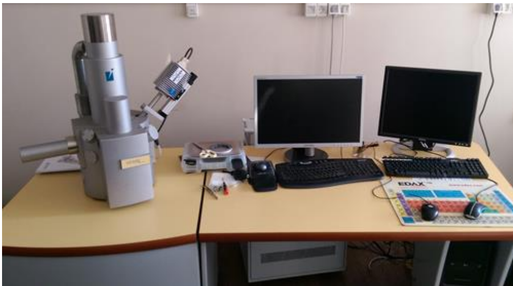
Slika 24. Fotografija pretražnog elektronskog mikroskopa TESCAN VEGA 5136 MM
