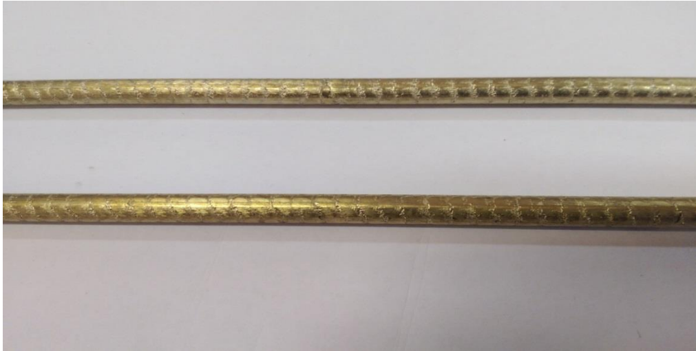
Slika 18. Fotografija cilindričnih šipki CuAlMn legure proizvedenih kontinuiranim vertikalnim lijevanjem
