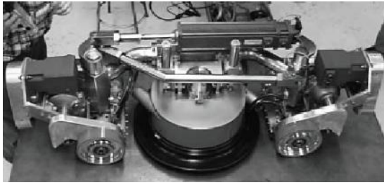
Рис. 4. Робот M2000 на базе магнитного транспортного устройства с колесной базой [5].
