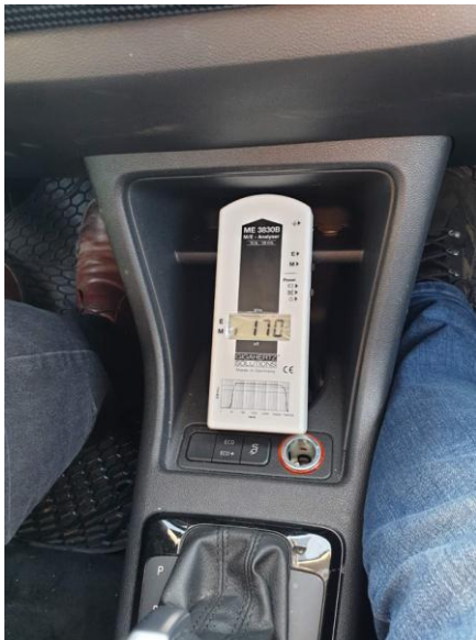
Фиг. 2. Измерване на магнитно поле в електрически автомобил
