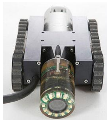
Рис. 2. Гусеничный робот-контроллер NanoMag [2].
