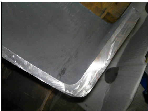
Slika 4.2. Kućište filtra KSF DN200 presječeno po visini radi ispitivanja poroznosti
