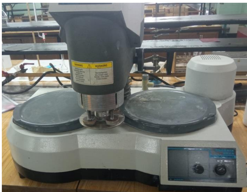
Slika 17. Uređaj za brušenje i poliranje
