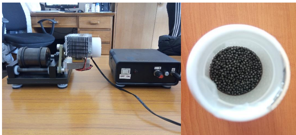
Slika 15. Kuglični mlin i kuglice za miješanje
