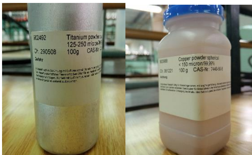
Slika 10. Polazni prahovi titana i bakra
