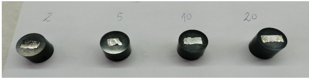
Slika 37. Uzorci nakon prešanja u vodljivu masu
