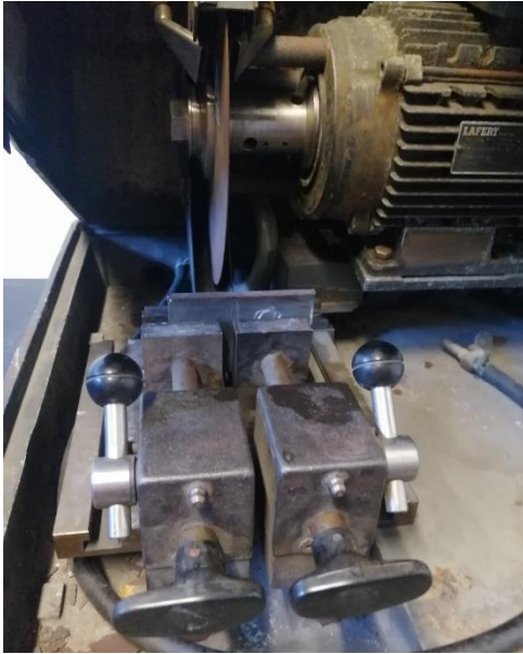
Slika 32. Postavljanje uzorka u stege
