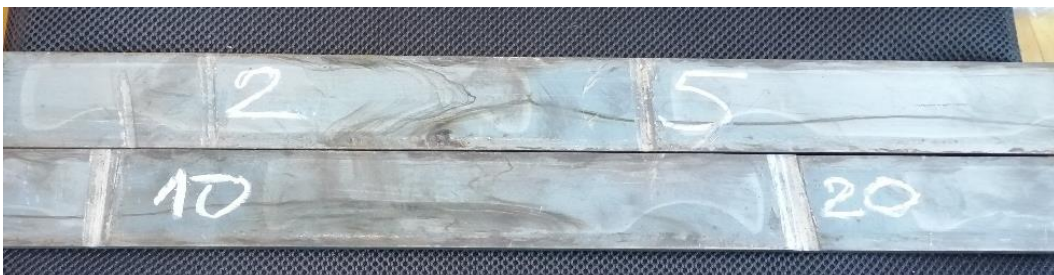
Slika 28. Trakasti uzorci nakon kovanja uz oznaku broja udaraca batom
