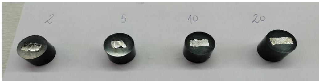
Slika 37. Uzorci nakon prešanja u vodljivu masu
