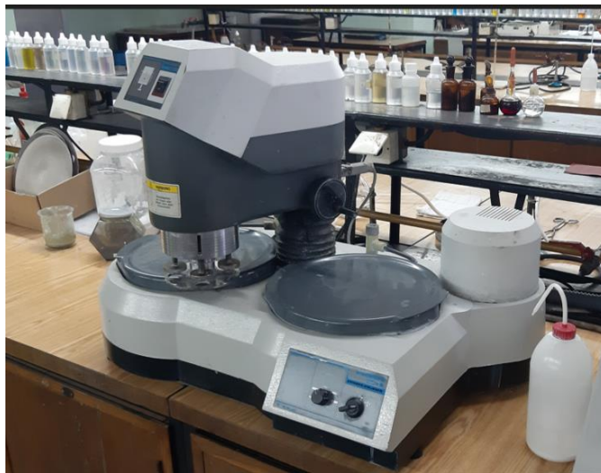
Slika 38. Uređaj za brušenje i poliranje "BUEHLER Phoenix Beta"
