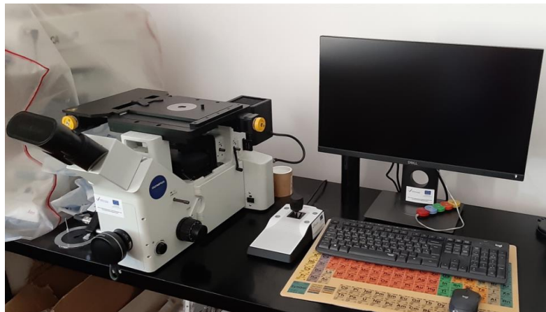
Slika 43. Invertni metalografski mikroskop Olyimpus GX51 s digitalnom kamerom DP70
