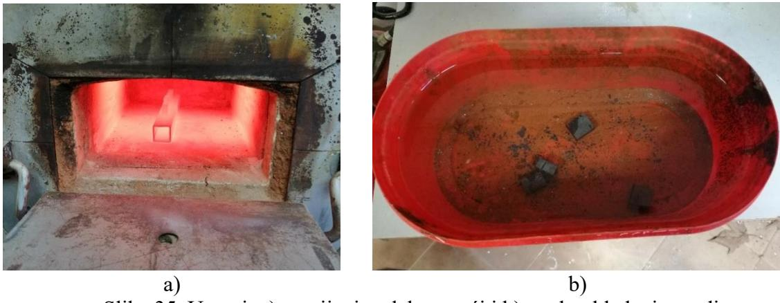
Slika 35. Uzorci: a) zagrijani u elektro peći i b) naglo ohlađeni u vodi
