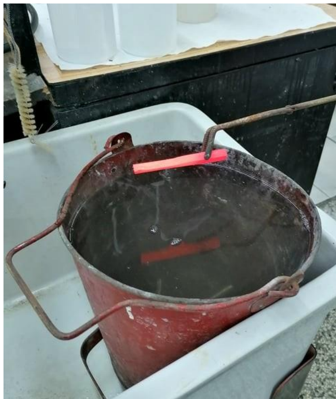
Slika 25. Hlađenje CuAlMnZr SMA legure u vodi do sobne temperature
