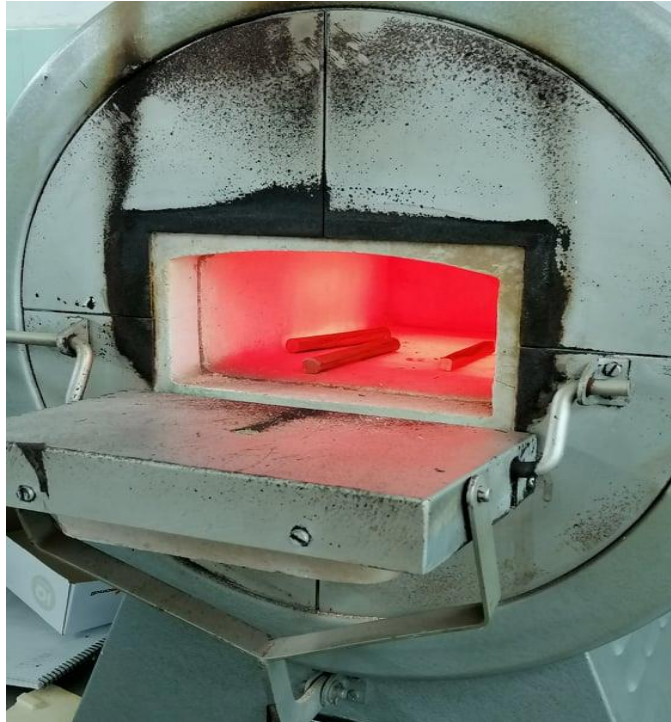
Slika 24. Zagrijavanje CuAlMnZr SMA legure u elektrootpornoj komornoj peći
