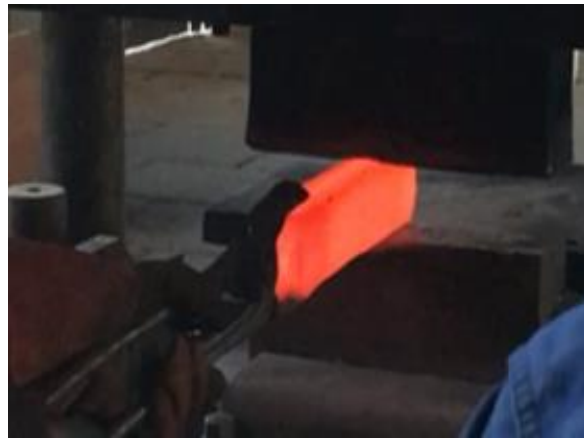
Slika 22. Kovanje CuAlMnZr SMA legure
