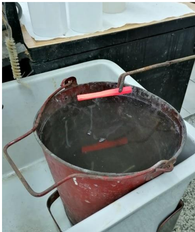
Slika 25. Hlađenje CuAlMnZr SMA legure u vodi do sobne temperature
