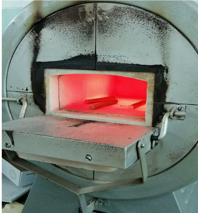
Slika 24. Zagrijavanje CuAlMnZr SMA legure u elektrootpornoj komornoj peći
