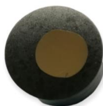
Slika 29. Fotografski snimak uzorka CuAlMnZr SMA legure nakon pripreme
