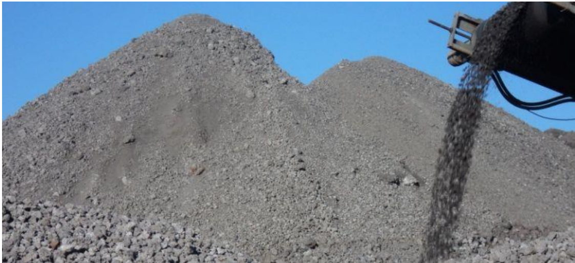
Slika 9. Odlaganje crne troske nastale proizvodnjom ugljičnih čelika u elektrolučnoj peći [17]
