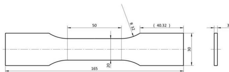
Slika 12. Nacrt uzorka za ispitivanje
