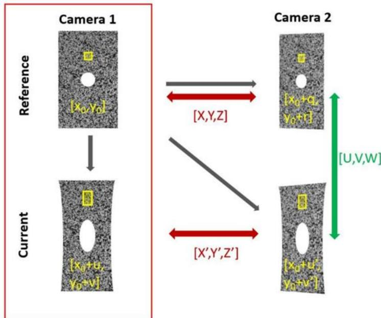
Slika 10. Princip rada 3D DIC metode [24]
