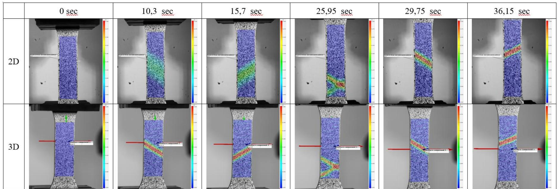
Slika 18. Usporedba DIC prikaza raspodjele brzine deformacije tijekom eksperimenta određenih 2D i 3D DIC metodom
