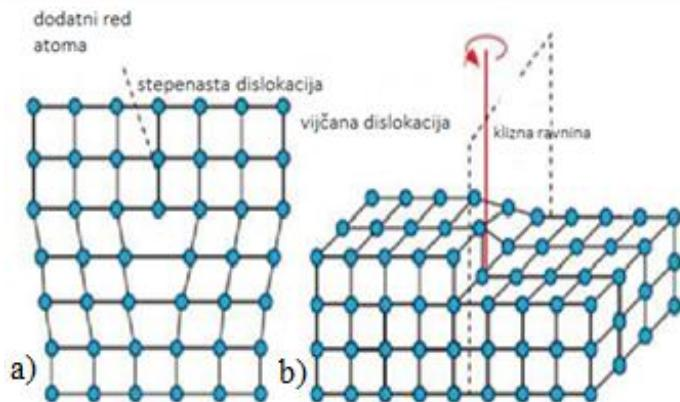
Slika 1. a) Rubna dislokacija, b) vijčana dislokacija [7]
