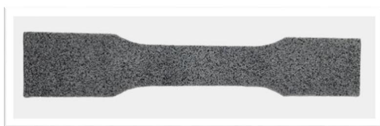
Slika 13. Pripremljeni uzorak za DIC ispitivanja
