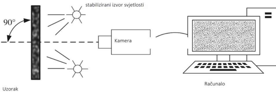
*Slika 9. Shematski prikaz 2D DIC metode [20]*
