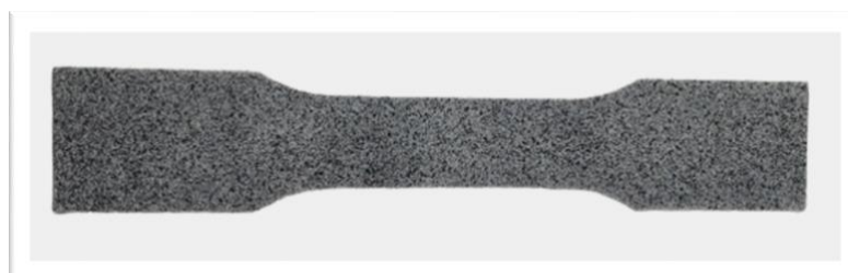
Slika 13. Pripremljeni uzorak za DIC ispitivanja
