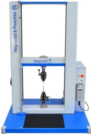
Slika 6. Kidalica za statička ispitivanja do 100 kN [13]
