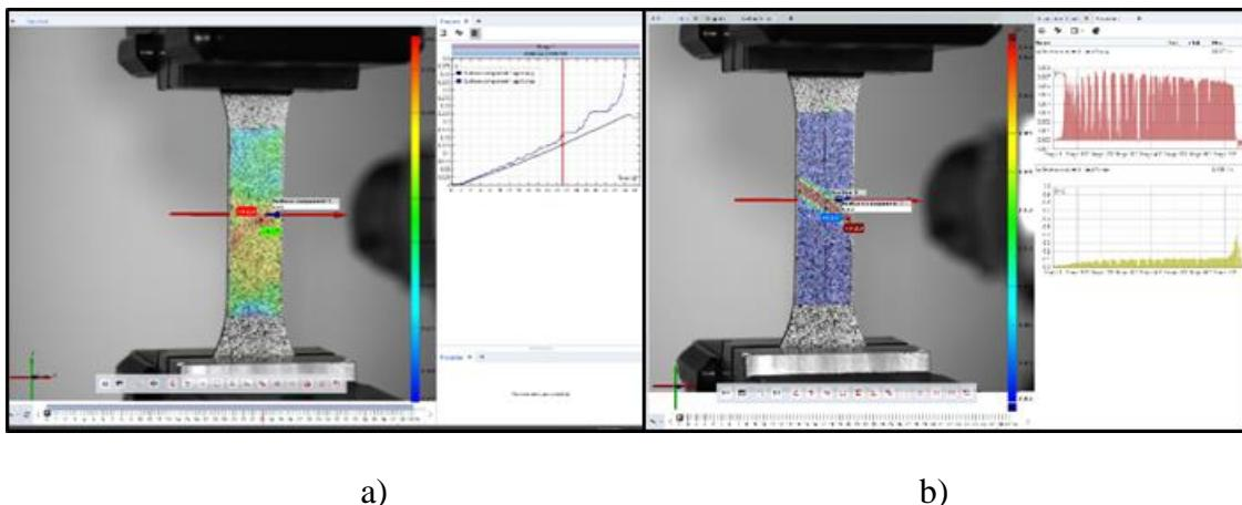
Slika 16. DIC analiza tijekom statičkog vlačnog pokusa: a) analiza deformacije, b) analiza brzine deformacije
