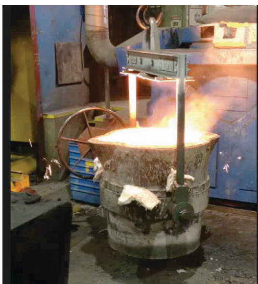
Slika 43. Cijepljenje u lonac [42].
