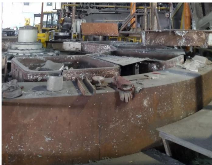
Slika 16. Rotacijski kalupi (karusel)
