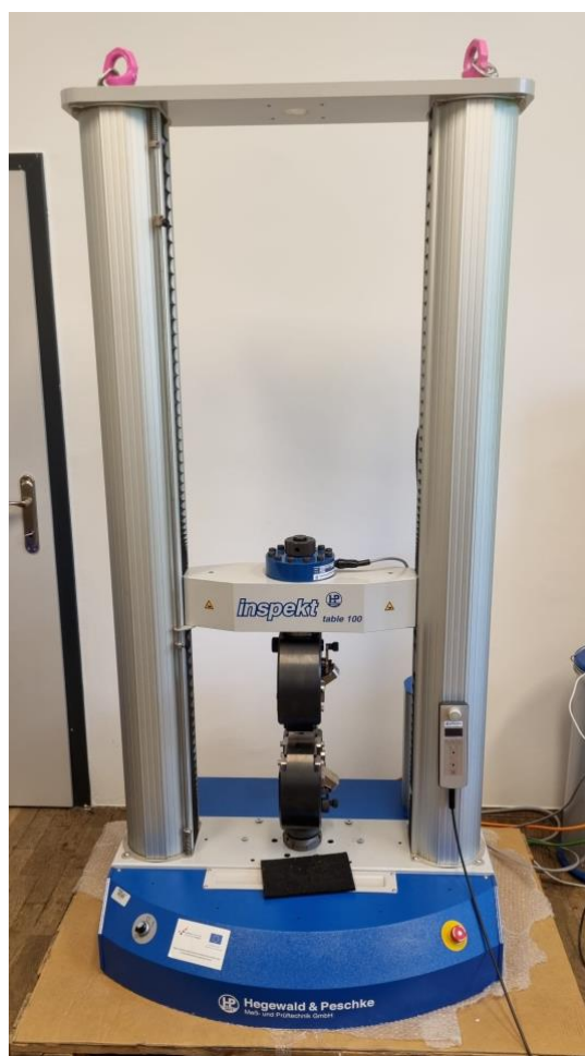
Slika 23. Kidalica Hegewald & Peschke Inspekt table 100
