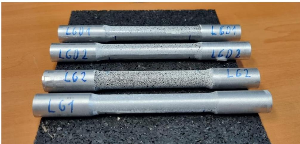
Slika 21. Uzorci okruglog poprečnog presjeka
