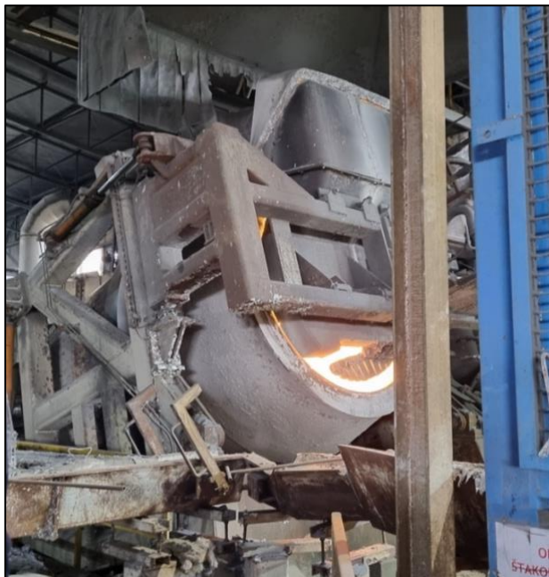
Slika 15. Rotacijska nagibna peć
