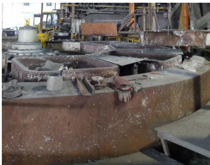
Slika 16. Rotacijski kalupi (karusel)
