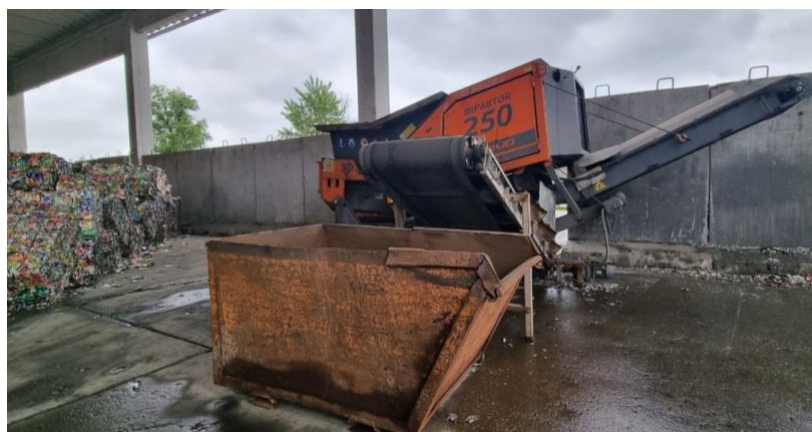
Slika 14. Šreder s magnetskim separatorom
