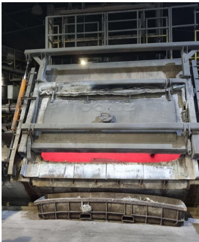
Slika 17. Peć za legiranje i održavanje taline
