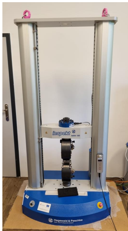
Slika 23. Kidalica Hegewald & Peschke Inspekt table 100
