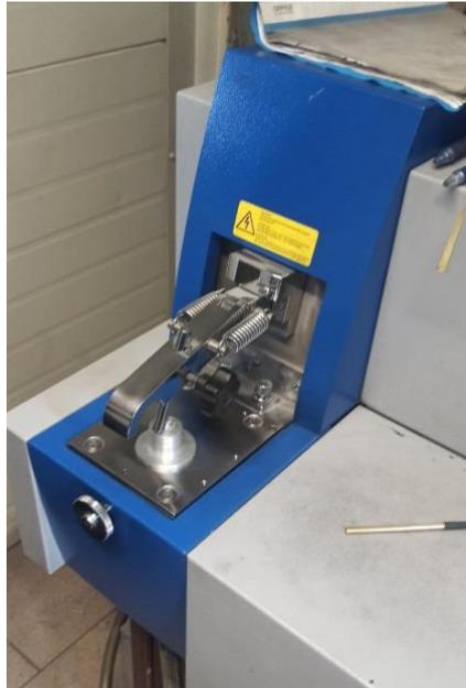
Slika 20. Spektrometar SPECTROMAXx
