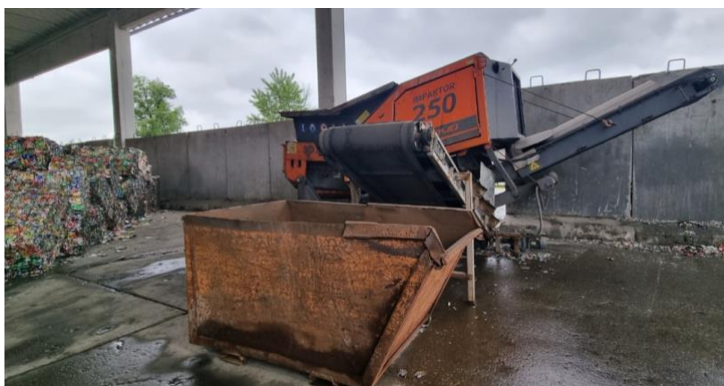
Slika 14. Šreder s magnetskim separatorom
