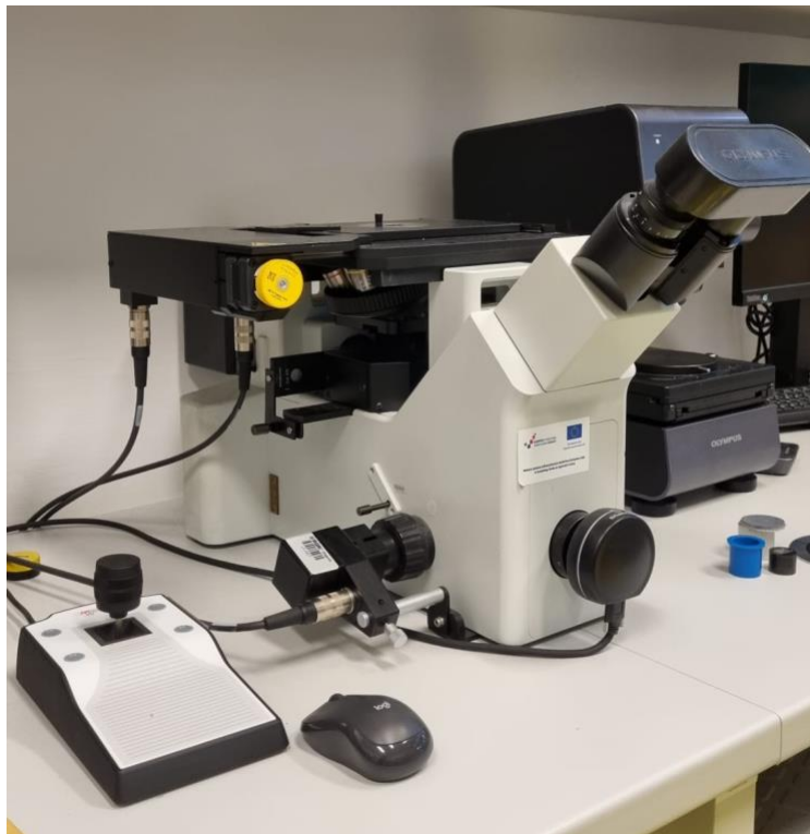
Slika 26. Metalografski mikroskop Olympus GX 51 s digitalnom kamerom DP 27
