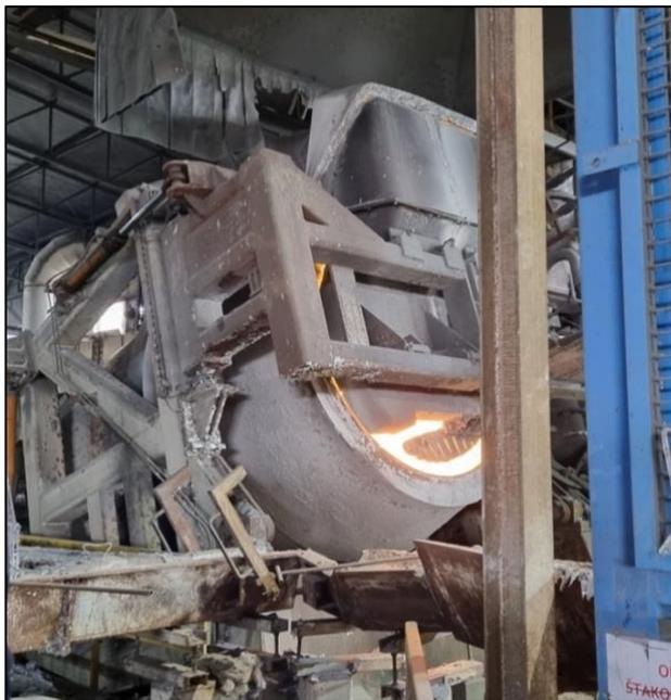
Slika 15. Rotacijska nagibna peć
