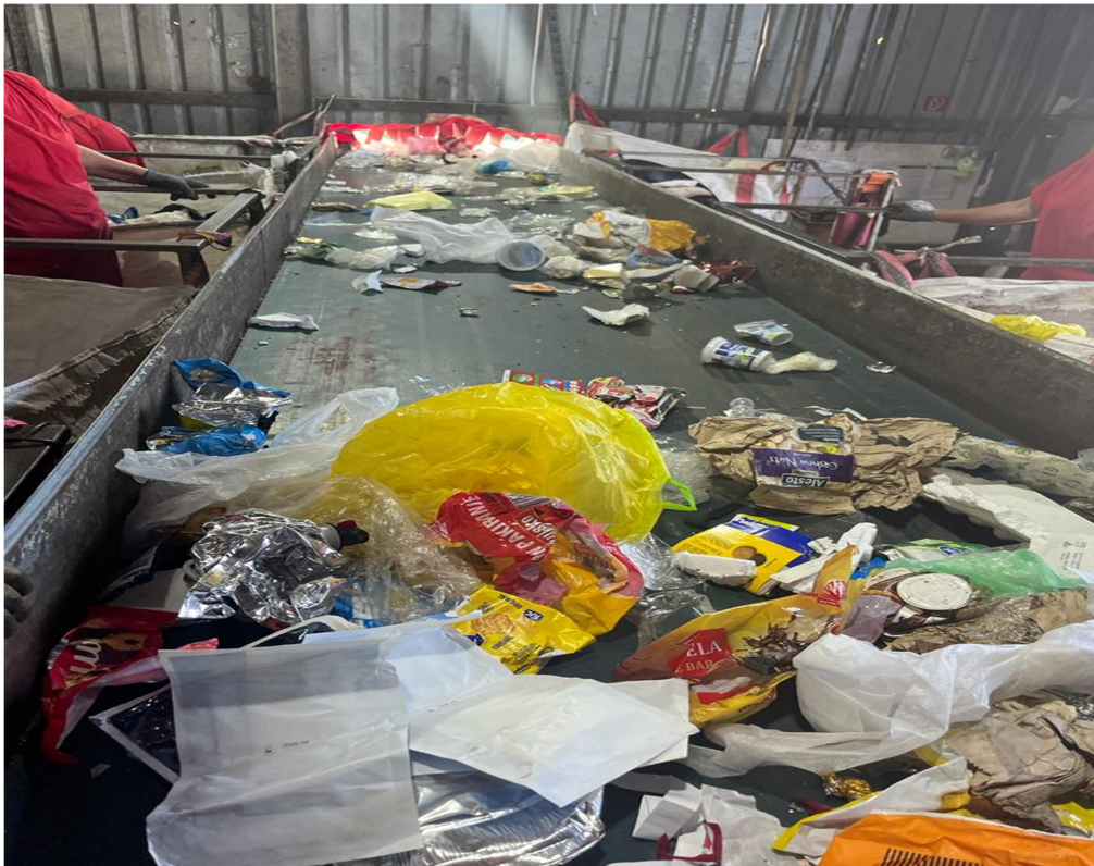
Slika 9. Horizontalna traka za ručno sortiranje otpada
