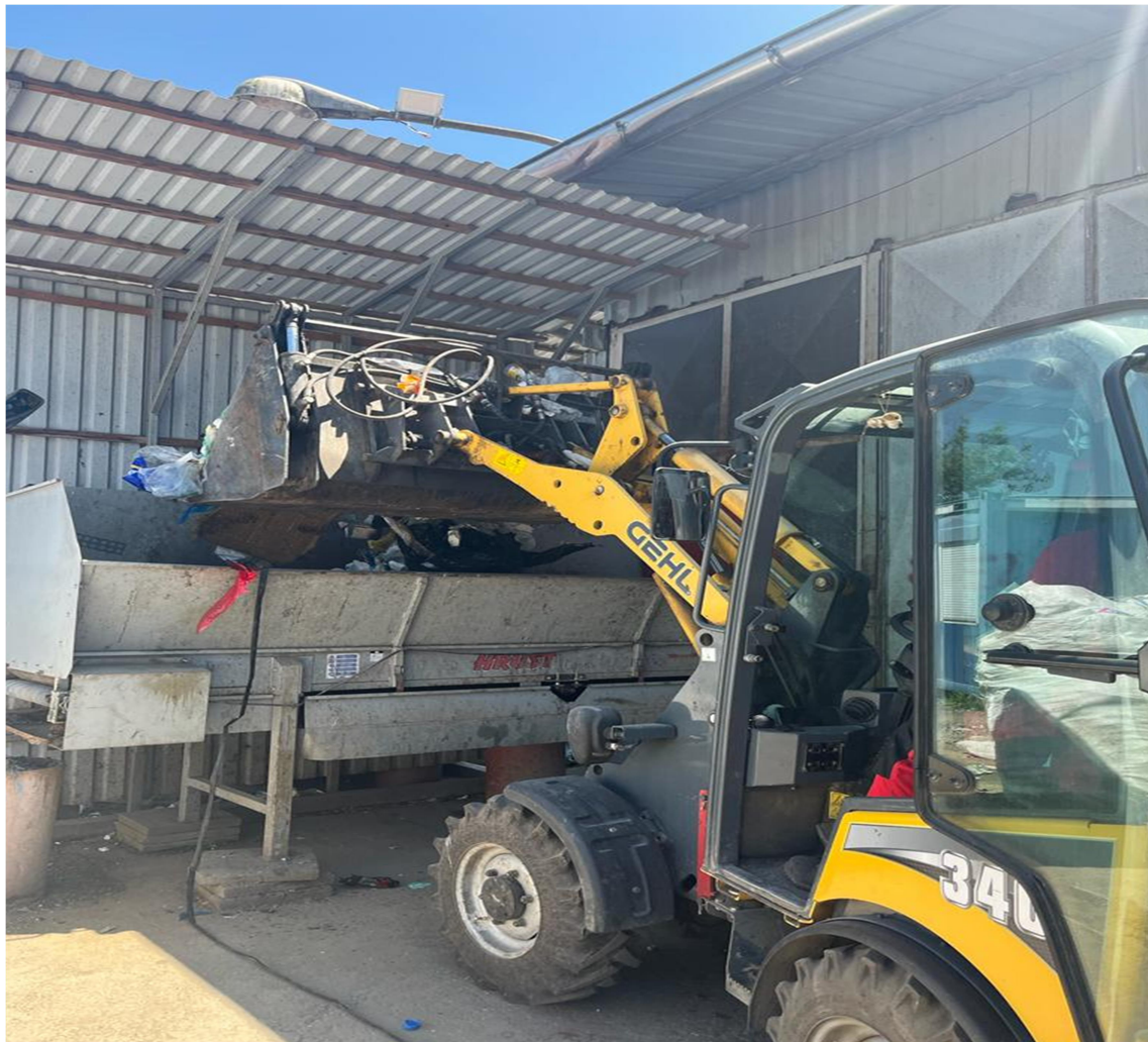
Slika 8. Istovar miješane ambalaže na ulaznu sortirnu traku
