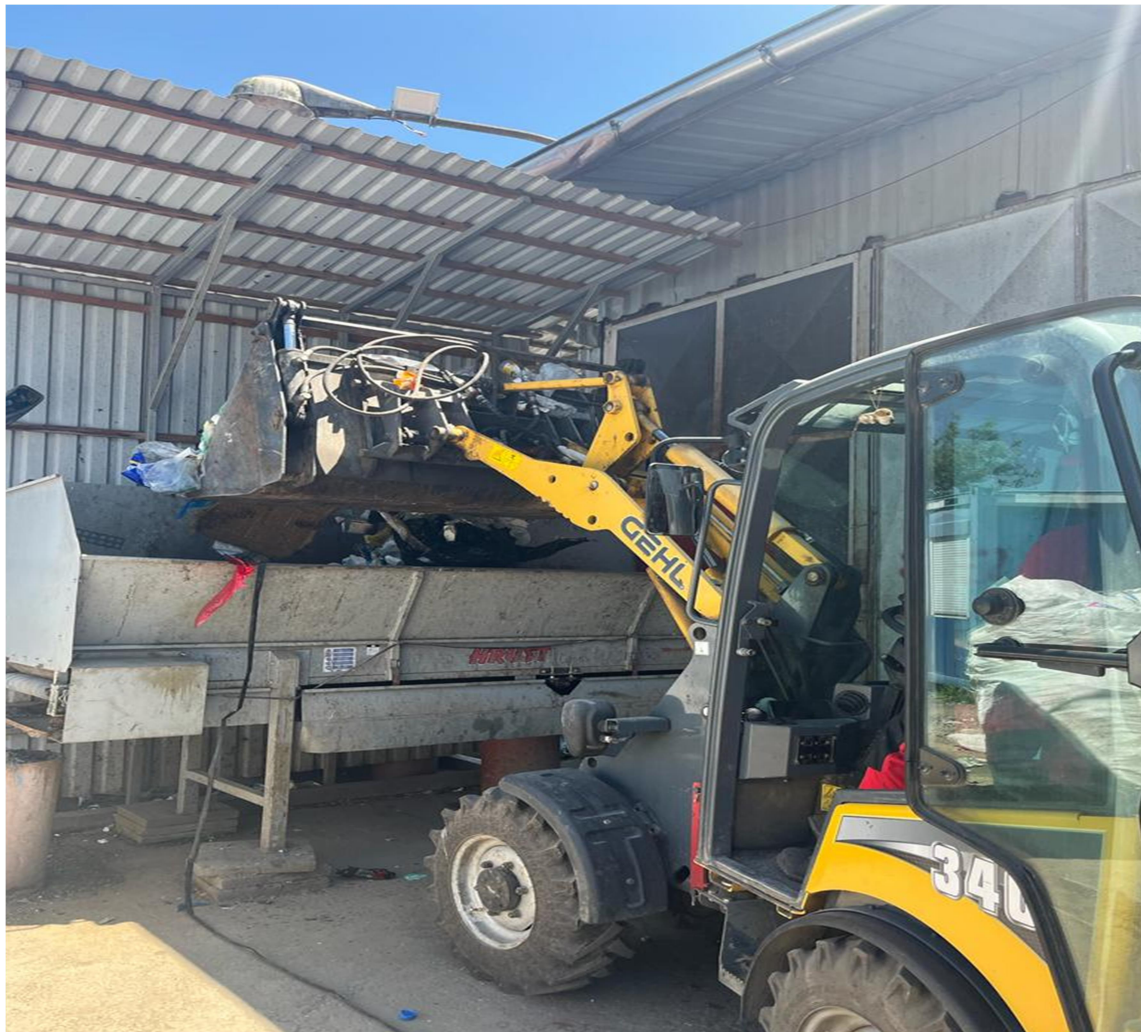
Slika 8. Istovar miješane ambalaže na ulaznu sortirnu traku
