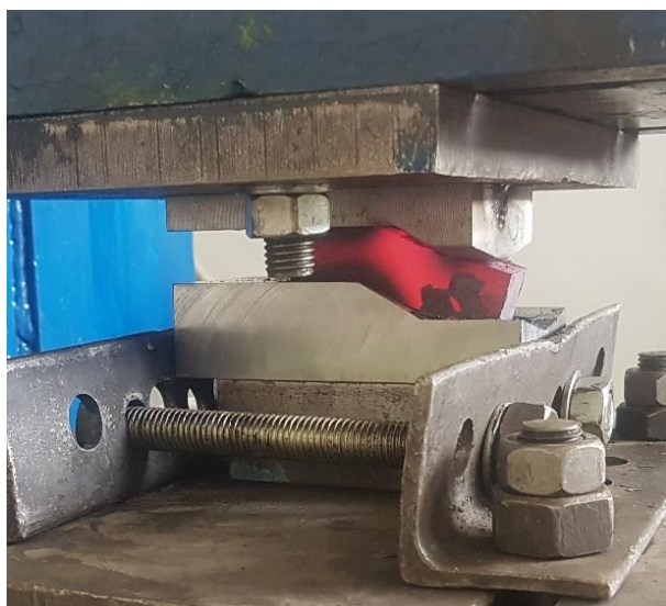
Рис. 2 Деформирование заготовки в ступенчато-клиновидных бойках новой конструкции
