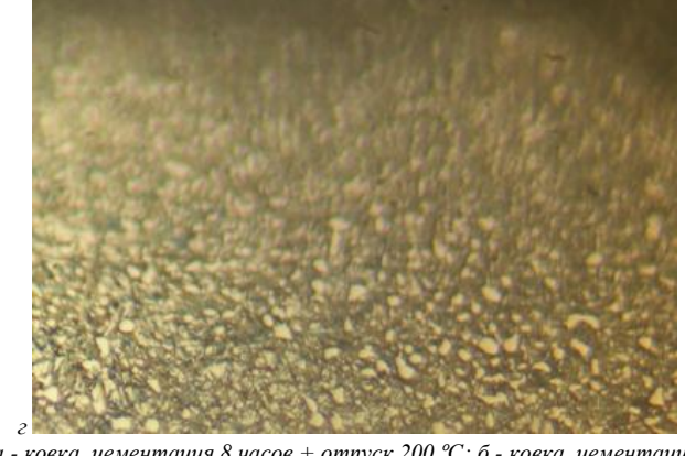
а - ковка, цементация 8 часов + отпуск 200 °С; б - ковка, цементация 12 часов + отпуск 200 °С; в - отжиг, цементация 8 часов + отпуск 200 °С; з - отжиг, цементация 12 часов + отпуск 200 °С
