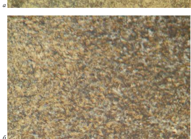
Рис. 1. Микроструктура стали 5XB2C после отжига (а), иковки (б); ×1000
