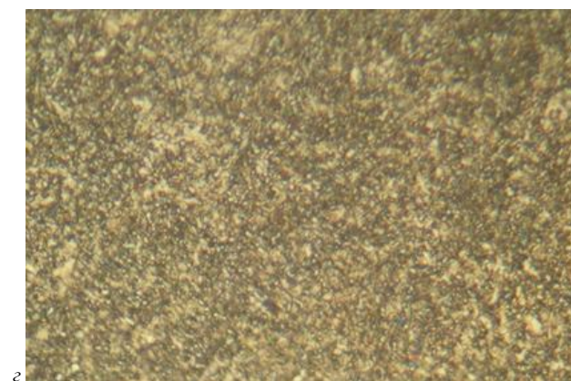
Рис. 2. Микроструктура стали 5XB2C после термической обработки; ×1000
