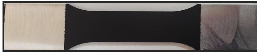
**Slika 25.** Epruveta s nanesenim crnim mat premazom
