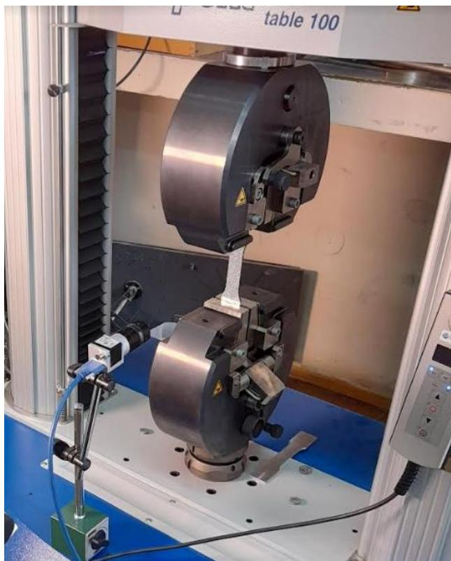
**Slika 28.** Položaj digitalne kamere tijekom ispitivanja
