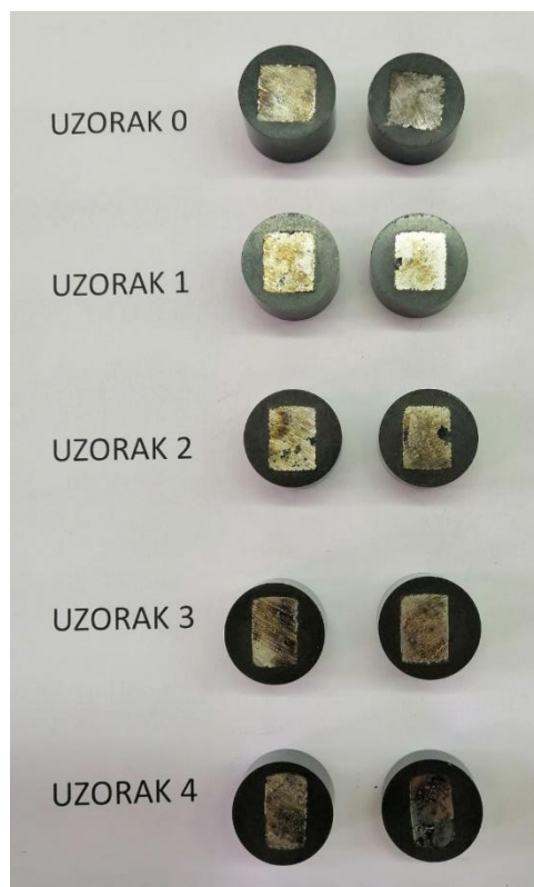
Slika 21. Uzorci nakon prešanja u vodljivu masu
