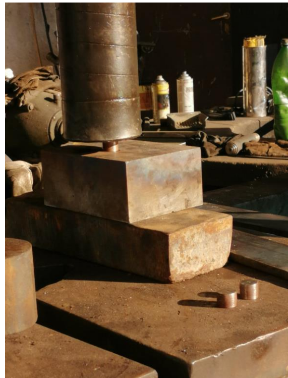
Slika 15. Sabijanje trećeg uzorka
