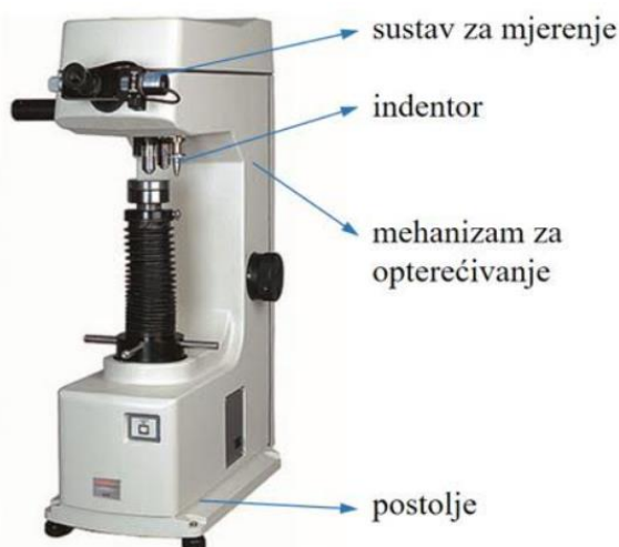
Slika 10. Tvrdomjer i njegove komponente [20]
