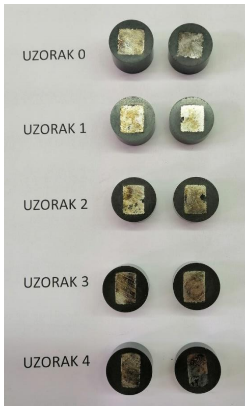
Slika 21. Uzorci nakon prešanja u vodljivu masu
