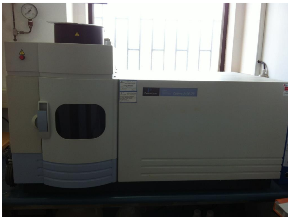
Slika 14. Spektrometar s induktivno spregnutom plazmom (ICP-OES)
