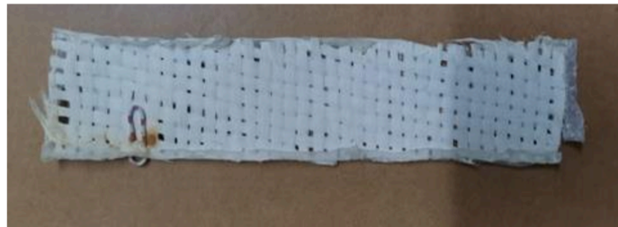
Slika 15. Prikaz staklene mrežice sa nanesenim \text{TiO}_2 slojem.
