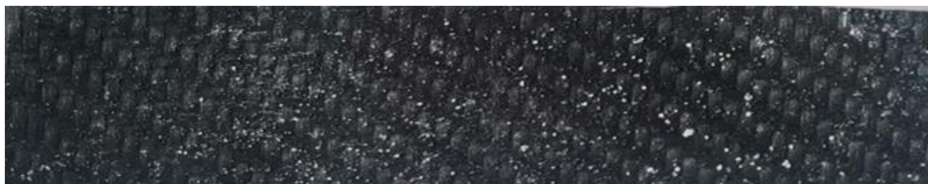
Slika 18. Karbonska mrežica s posipanim \text{TiO}_2 .
