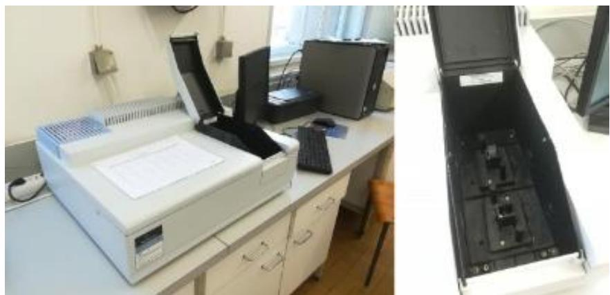
Slika 13. Prikaz UV/VIS spektrofotometra.
