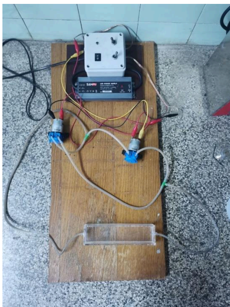
Slika 18. Reaktor za ispitivanje fotokatalitičkih svojstava.
