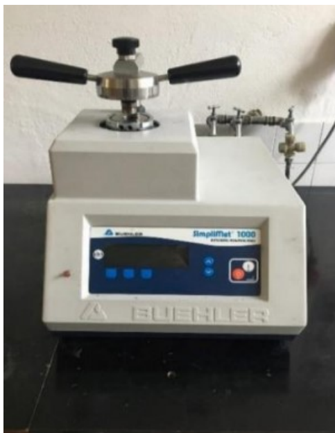
Slika 34. Fotografija uređaja za ulaganje uzoraka SimpliMet1000
