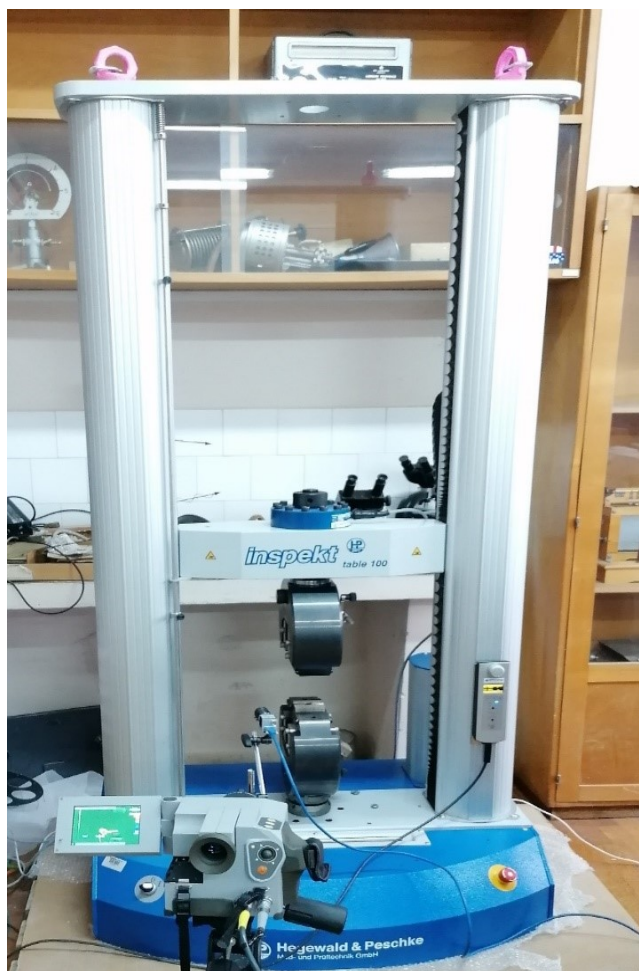
Slika 23. Prikaz kidalice Hegewald & Peschke Inspekt table 100
