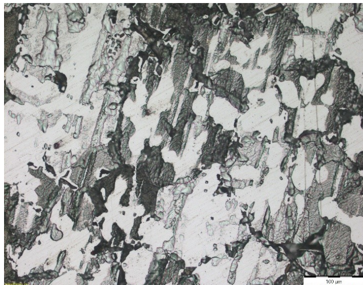
Slika 52. Mikrostruktura AlMg 4,5 legure na PLC liniji pri povećanju 200x
