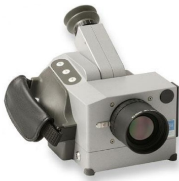
Slika 24. Prikaz termalne kamere Jenoptik VarioCAM® M82910
