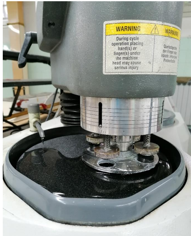
Slika 25. Prikaz uređaja za brušenje i poliranje uzoraka
