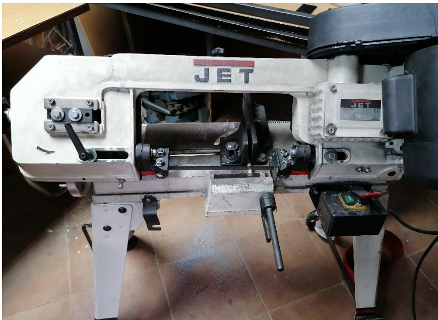
Slika 23. Prikaz JET rezalice uzoraka CuAlMn legure
