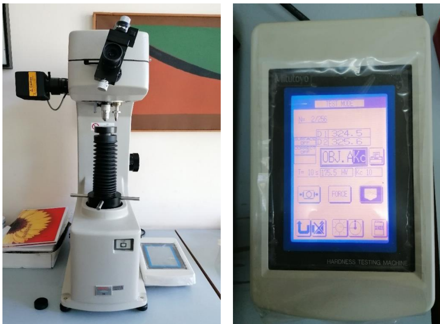
Slika 30. Prikaz uređaja za mjerenje tvrdoće
