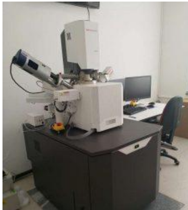
Slika 28. Pretražni elektronski mikroskop FEG-SEM Thermofisher Quattro S
