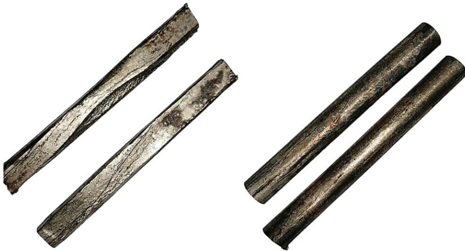
Slika 22. Uzorci CuAlMn legure nakon toplinske obrade
