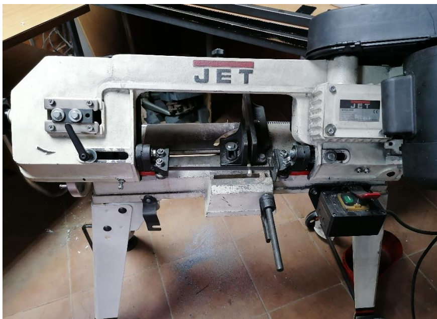
Slika 23. Prikaz JET rezalice uzoraka CuAlMn legure
