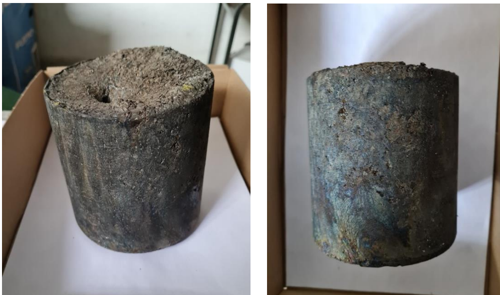
Slika 18. Lijevani ingot CuAlMn legure s prisjetljivosti oblika
