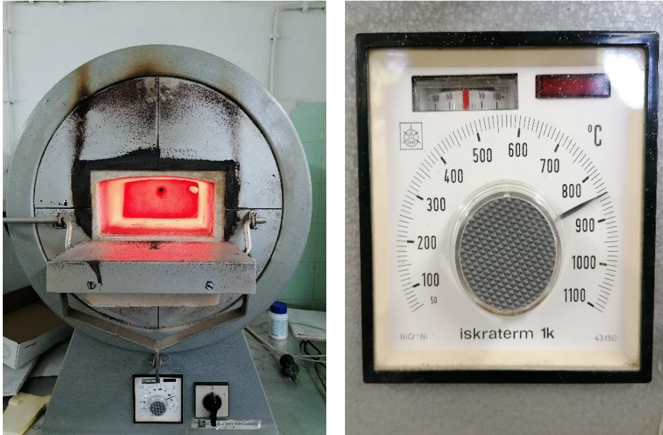
Slika 20. Prikaz elektrootporne peći i temperature žarenja uzoraka CuAlMn legure
