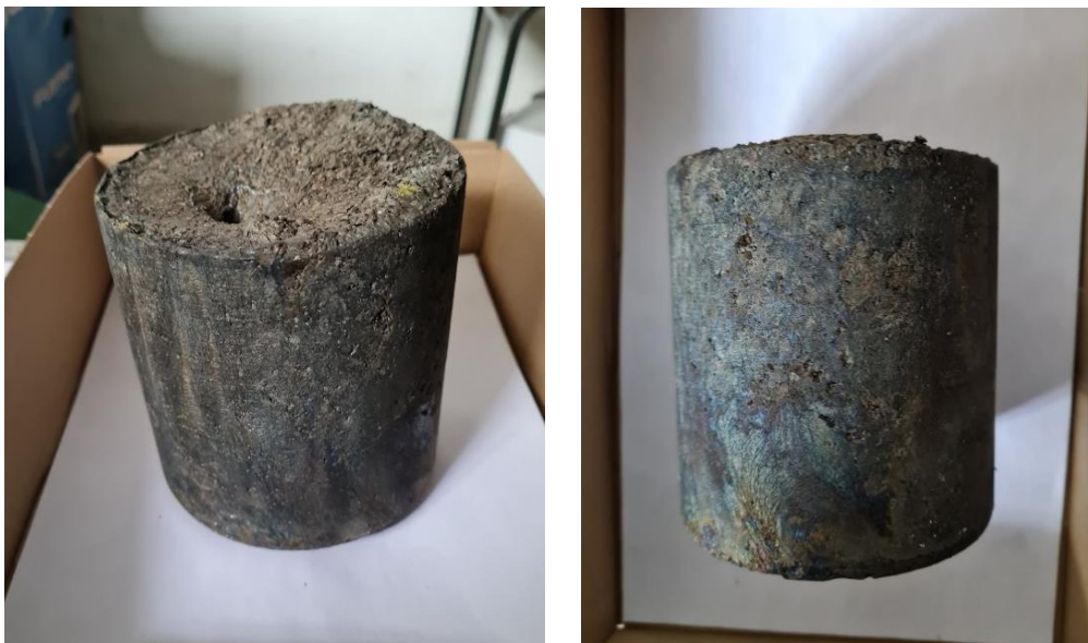
Slika 18. Lijevani ingot CuAlMn legure s prisjetljivosti oblika
