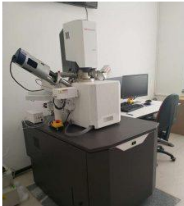
Slika 28. Pretražni elektronski mikroskop FEG-SEM Thermofisher Quattro S
