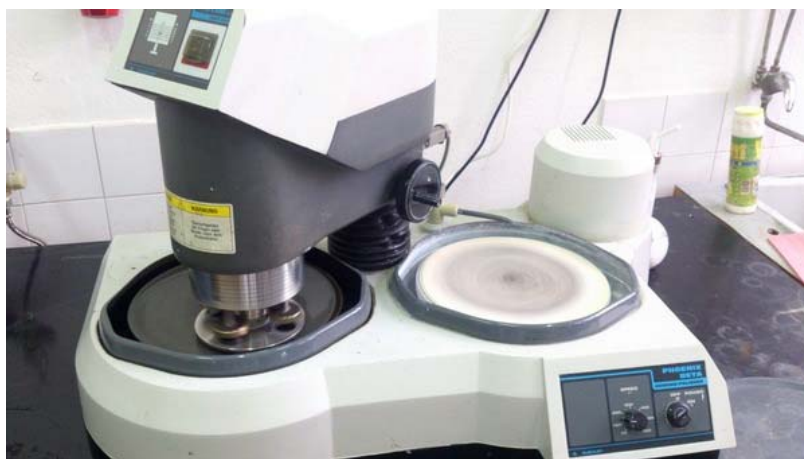
Slika 15. Uređaj PHOENIX BETA za brušenje i poliranje uzoraka
